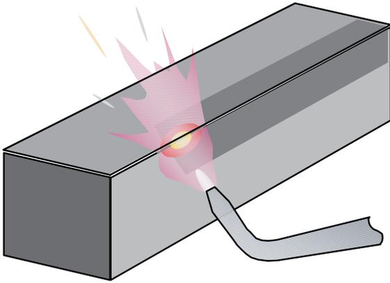
表面火焰淬火可用气体火焰连续加热到约850°C (浅红色)，然后空冷。气体火焰可采用乙炔焰。调整气体管道的尺寸和火焰温度使加热过程能在几秒钟内完成。
