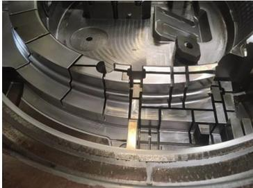
用于生产吹风机零件的模具镶件就是其中之一，此镶件被用于高度优化和自动化、每天生产近1000个零件的生产线上。为了提高生产率和缩短生产周期，该公司放弃使用传统的模具钢制作模具，开始尝试新方法。这些方法包括将模具的材料改为铝和铍铜，但同时也使用了一个通过增材制造加工而成的镶件。
